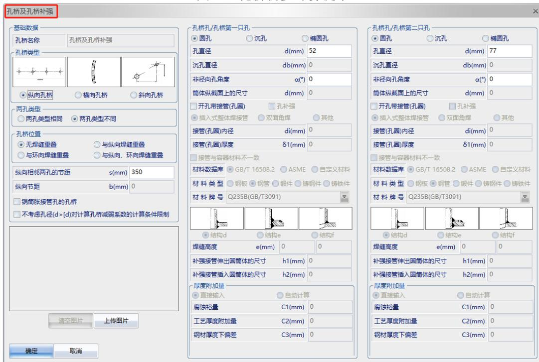
图 4.5 孔桥及孔桥加强界面
