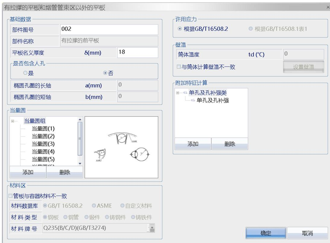
图 3.9 基本受压元件原始数据输入界面（以有拉撑的平板为例）
